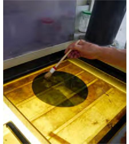
Abb. 15: Zum Entfärben kommt das abgeklebte Glas in ein Flußsäurebad
